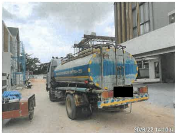
รูปที่ 2-27 แสดงการติดแผ่นป้ายสะท้อนแสงบริเวณท้ายรถขนส่งวัสดุก่อสร้าง
