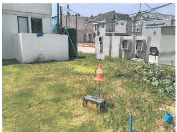
รูปที่ 2-11 แสดงการติดตั้งอุปกรณ์เครื่องตรวจวัดฝุ่น เสียง และสั่นสะเทือนภายในพื้นที่ก่อสร้าง
