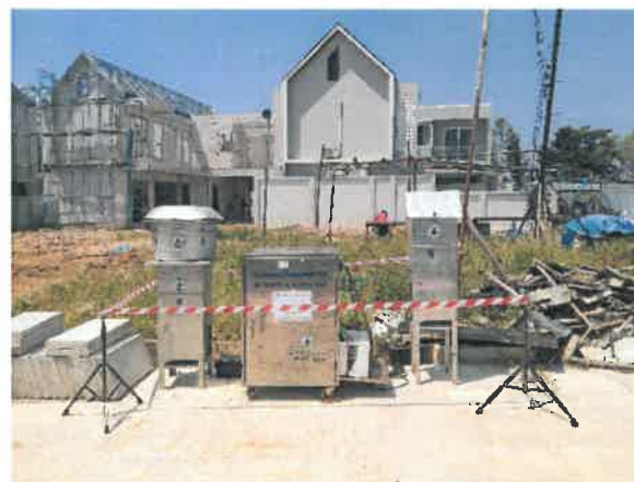
รูปที่ 2-11 แสดงการติดตั้งอุปกรณ์เครื่องตรวจวัดฝุ่น เสียง และสั่นสะเทือนภายในพื้นที่ก่อสร้าง
